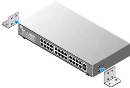
3. 将交换机靠墙放置，并透过支架上的孔在墙上作标记。
